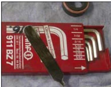
Монтаж торцевого уплотнения. Для корректной работы торцевого уплотнения с помощью щупа нужно установить рабочий зазор 1,5 мм.
