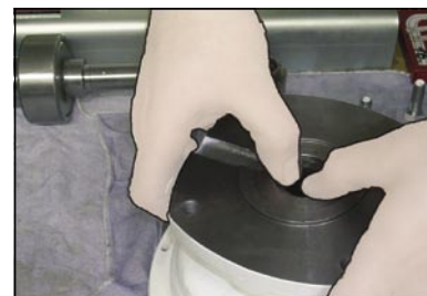
Демонтаж неподвижной части торцевого уплотнения
