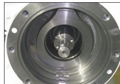
Центральный вал с торцевым уплотнением
