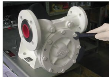
Демонтаж крышки насоса
