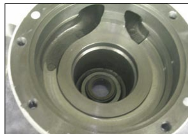
Внутренний вид демонтированной рабочей камеры
