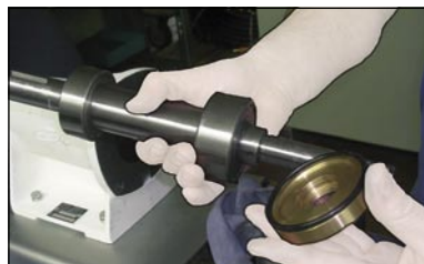
Демонтаж опорной шайбы
