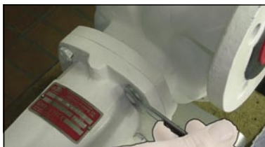
Подготовка к демонтажу рабочей камеры и ступицы вала
