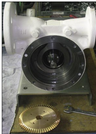
Демонтированное рабочее колесо
