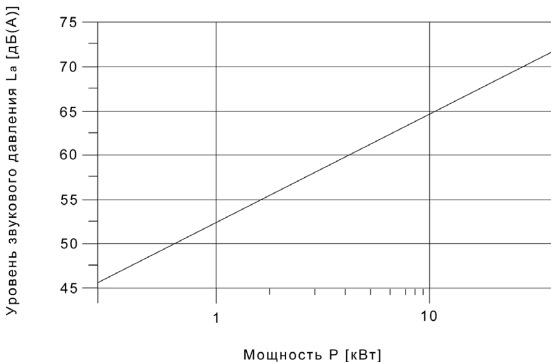
Приблизительные значения шума для открыто-вихревых насосов при оборотах n=1450 1/мин
