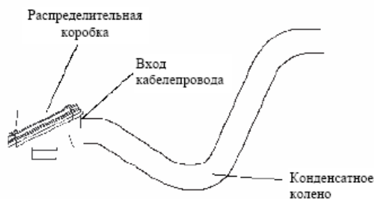
Рисунок 3-2. Конденсатное колено в кабелепроводе
