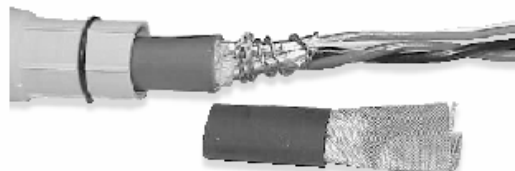
Экранированный провод (-а) утечки, дважды обмотанный вокруг открытого участка фольги
